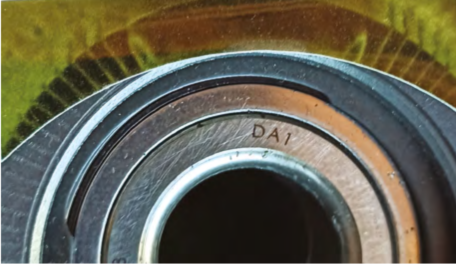
Rysunek 3. Uszkodzony enkoder magnetyczny, zweryfikowany kartą MaXgear 89-0051.
