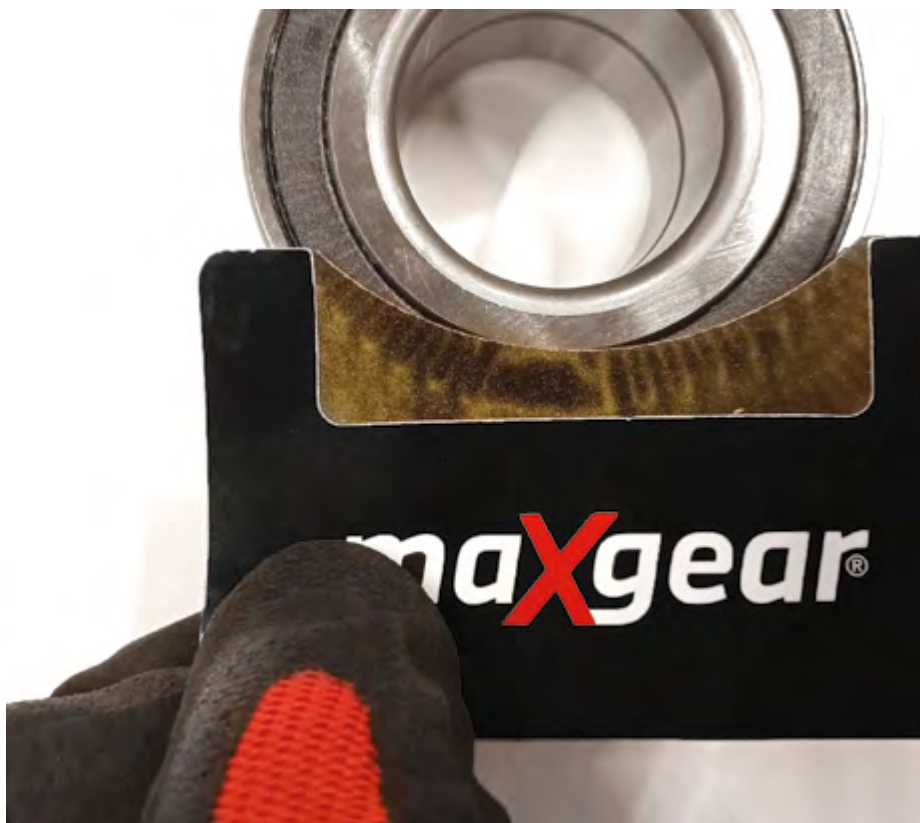
Rysunek 2. To samo łożysko po weryfikacji kartą MaXgear 89-0051 – widoczne uszkodzenia enkodera.
