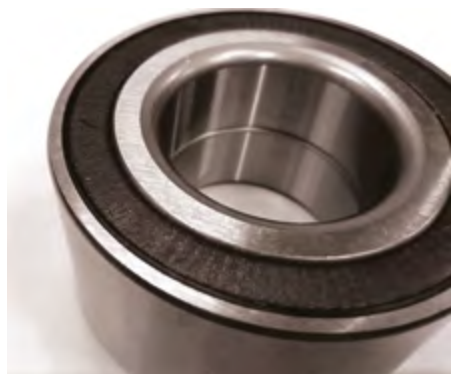
Rysunek 1. Uszczelnienie łożyska koła – brak widocznych uszkodzeń w ocenie wizualnej.
