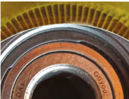
Rysunek 3.1. Nieuszkodzony enkoder magnetyczny, zweryfikowany kartą MaXgear 89-0051.
