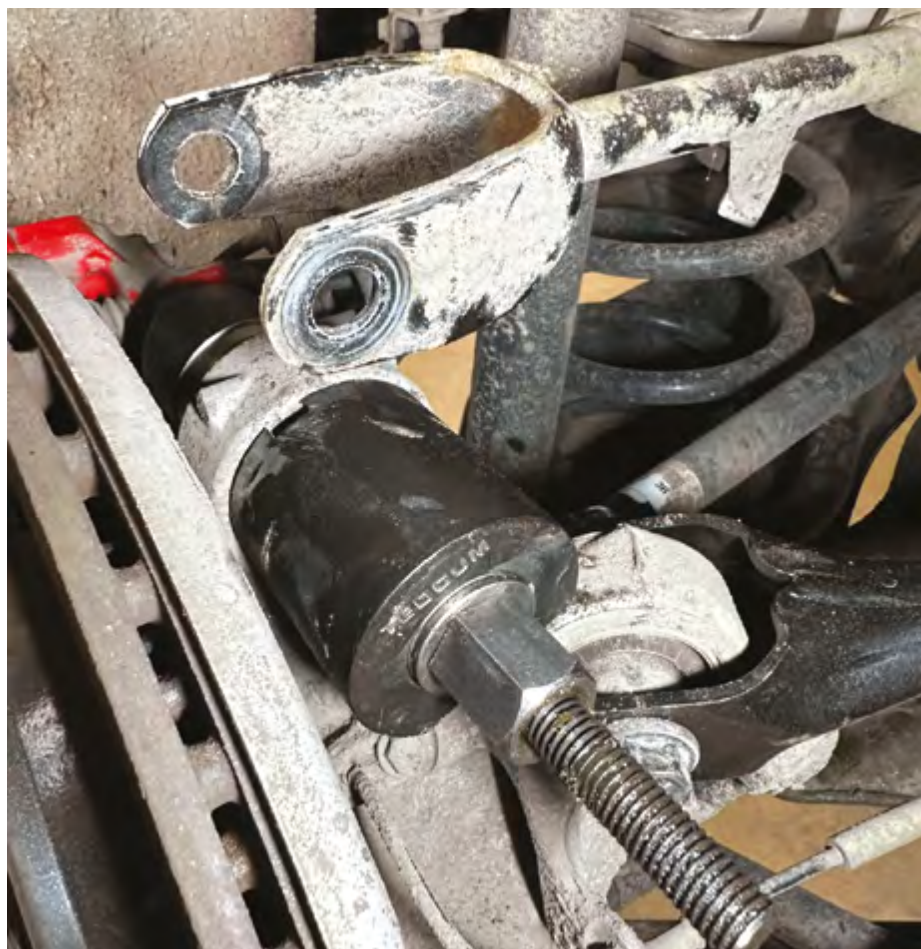
Ściągacz TED31496 podczas wymiany tulei w samochodzie Tesla Model Y
