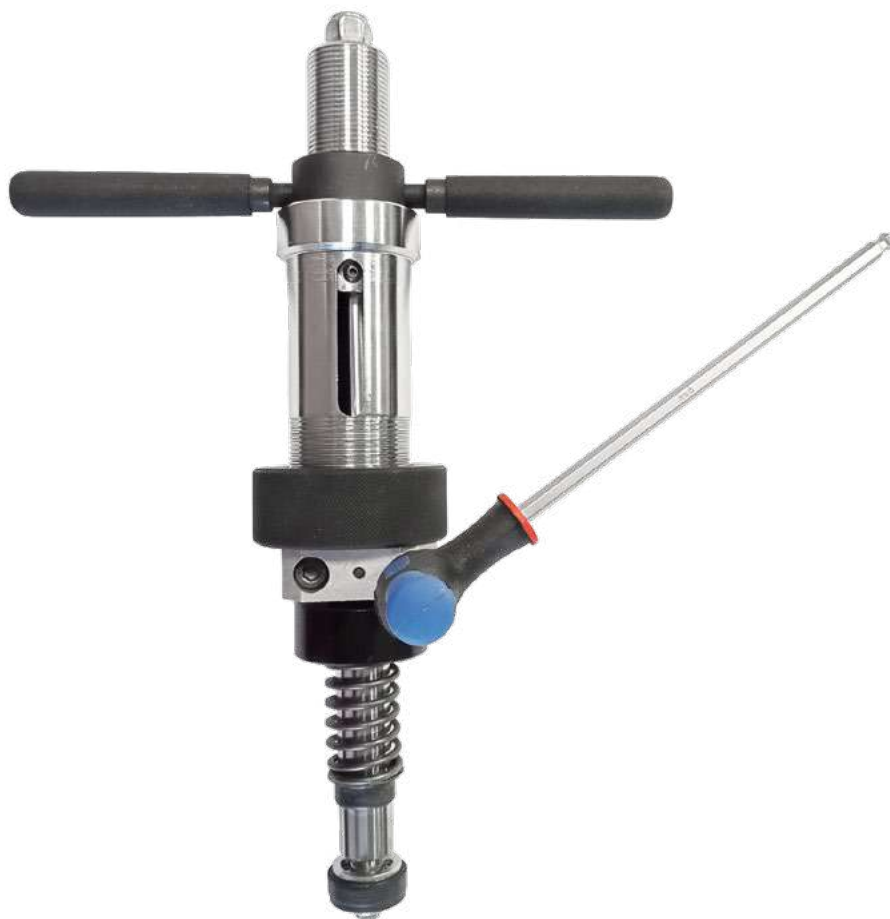
■ Rysunek 6. Dokręcanie ścisku z wkładkami teflonowymi (z zestawu ROOKS OK-02.1000) na tłoczysku amortyzatora. Dla zobrazowania procesu – zamontowany na elementach składowych amortyzatora MaXgear 11-0098.
