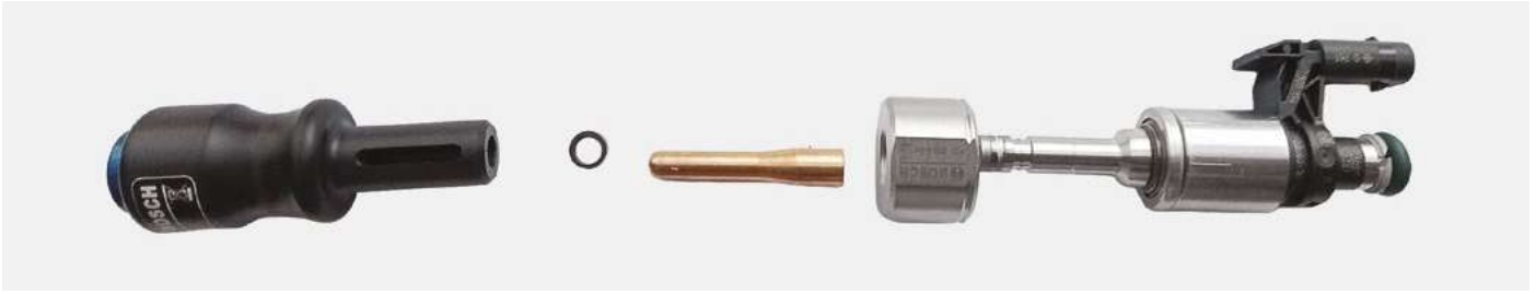
■ Rysunek 4. Kolejność zamontowanych elementów podczas procesu osadzania uszczelnienia wtryskiwacza
