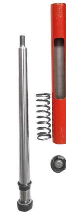
■ Rysunek 3. Elementy budowy wewnętrznej amortyzatora dwururowego MaXgear 11-0098. Przekrój amortyzatora.
