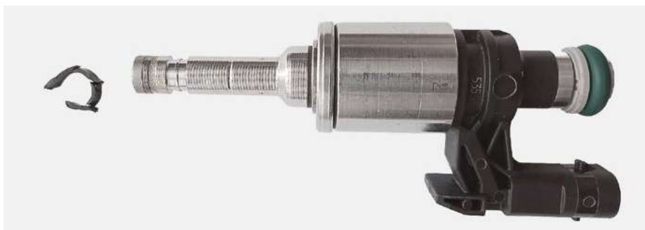
Rysunek 3. Zdemonstrowany stary uszczelniacz z wtryskiwacza.
