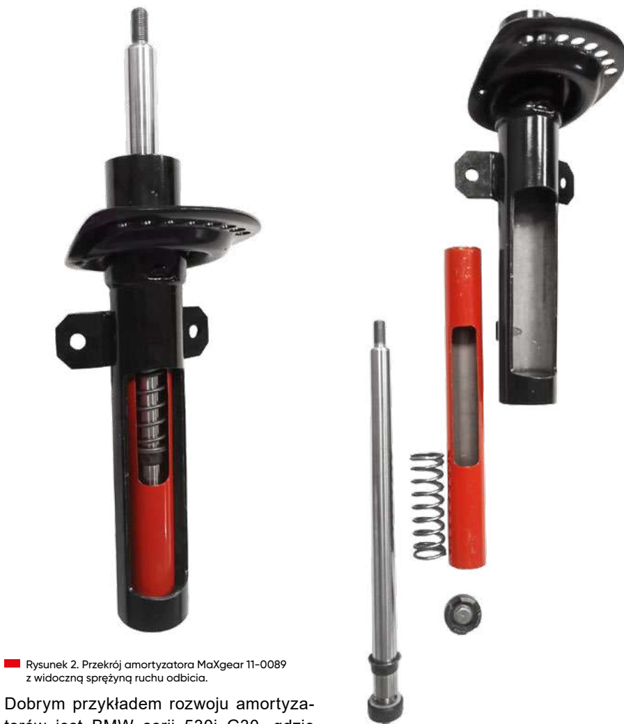
■ Rysunek 3. Elementy budowy wewnętrznej amortyzatora dwururowego MaXgear 11-0098. Przekrój amortyzatora.
