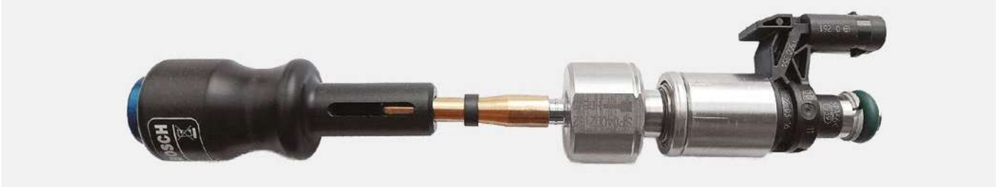
■ Rysunek 5. Odpowiednio ułożone elementy. Uszczelniacz ma średnicę mniejszą, niż końcówka wtryskiwacza.
