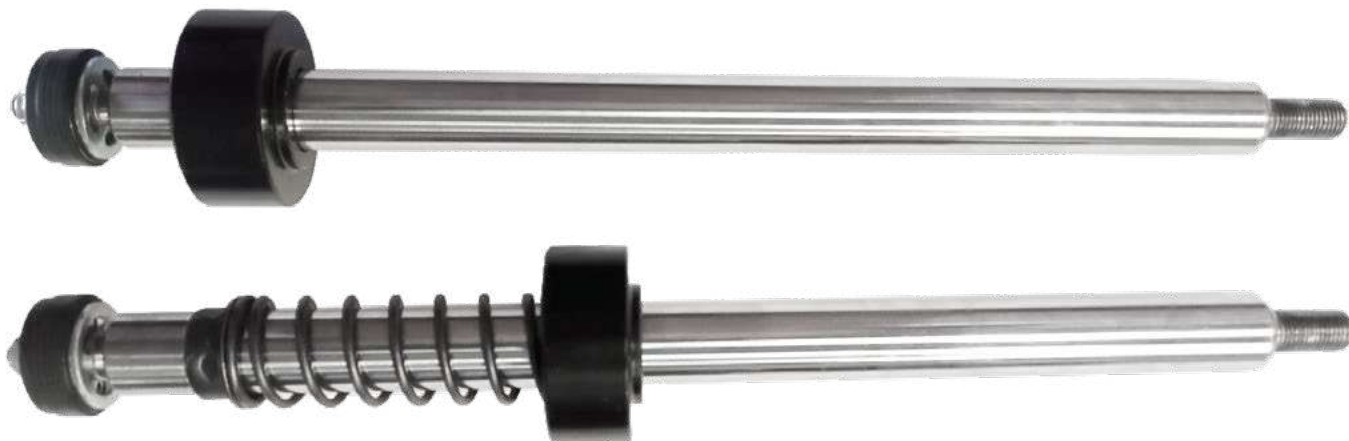
■ Rysunek 1. Porównanie budowy wewnętrznej amortyzatora bez sprężyny (górny) i ze sprężyną ruchu odbicia (dolny).
