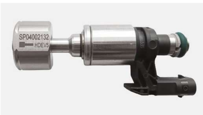
■ Rysunek 7. Zsuwanie tulei kalibracyjnej, przygotowującej uszczelnienie do wymiaru docelowego. Zsuwając należy wykonywać okrężne ruchy tulei kalibracyjnej.
