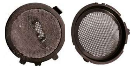
Rysunek 8. Zabrudzony filtr siatkowy powietrza chłodzenia akumulatora trakcyjnego Auris 1,8 Hybrid
