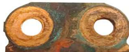
Rysunek 4. Uszkodzony łącznik modułów akumulatora trakcyjnego. Widoczne ubytki materiału. Toyota Auris Hybrid
