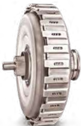
■ Budowa zewnętrzna i składowe mokrego sprzęgła podwójnego
