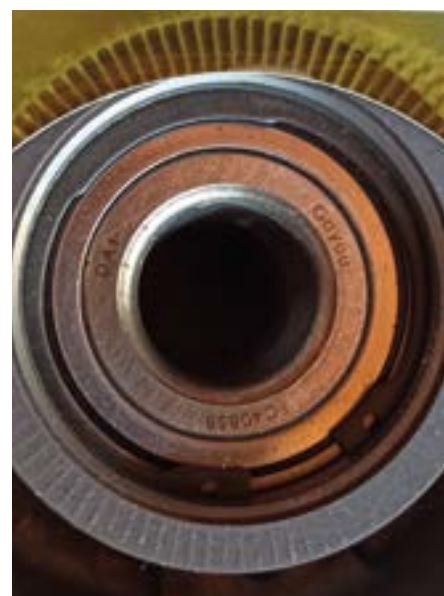
Fot. 7. Poprawny enkoder magnetyczny, wszystkie pola równe i bez zniekształceń
