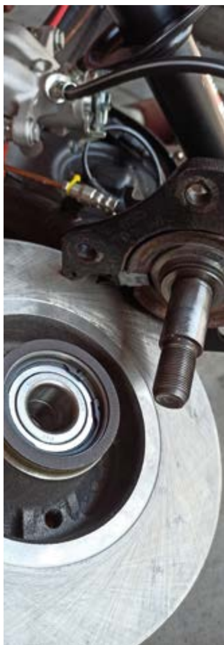
Fot. 6. Zdemontowana tarcza hamulcowa wraz z enkoderem magnetycznym
