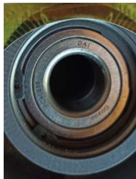
Fot. 8. Uszkodzony enkoder magnetyczny, brak regularnych i równych pól magnetycznych. Widoczne jedno pole magnetyczne
