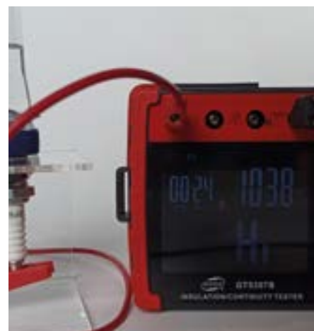
Fot. 4. Wynik pomiaru Magneti Marelli 007950024680 „Oil for Hybrid Compressors R134a”
