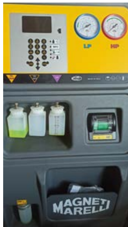
Fot. 7. Stacja robocza serwisu układów klimatyzacji Magneti Marelli. Widoczne 3 zbiorniki na nowy olej. Środkowy HEV przeznaczony do oleju dla sprężarek elektrycznych
