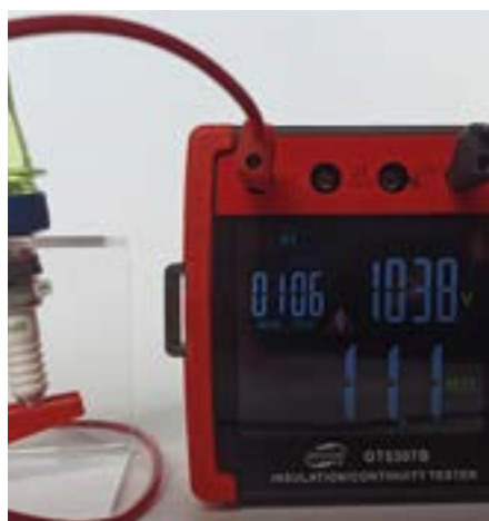
Fot. 3. Wynik pomiaru oleju PAG 46
