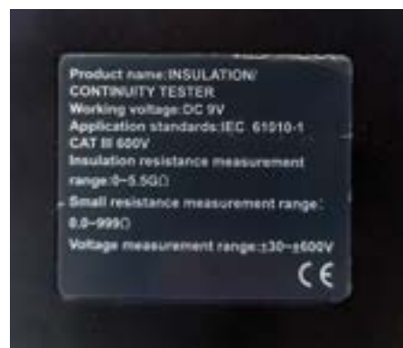
Fot. 6. Zakres pomiarowy miernika rezystancji izolacji
