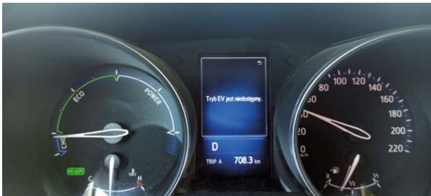
Fot. 10. Próba włączenia trybu EV MODE – kryterium prędkości spełnione. Temperatura akumulatora 47°C, ciągła praca silnika spalinowego
