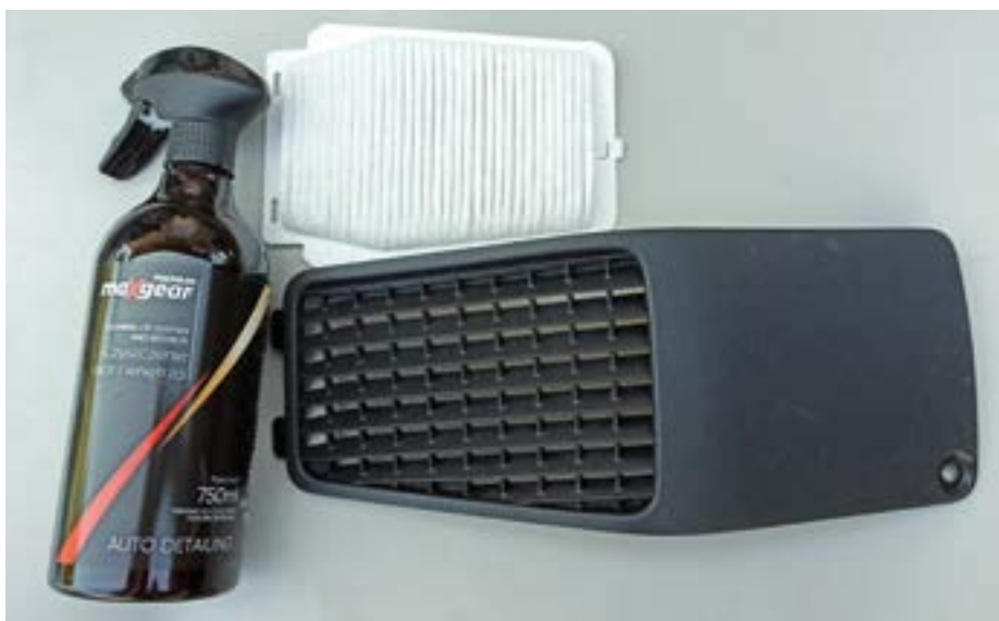
Fot. 5. Wyczyszczony wlot powietrza za pomocą środka MaXgear Premium do czyszczenia skór i wnętrza. Obok widoczny nowy filtr
