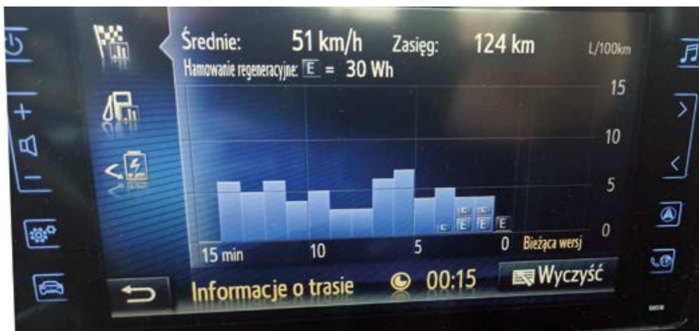
Fot. 11. Widok komputera pokładowego – hamowanie regeneracyjne (symbol E na grafice) możliwe dopiero przy temperaturze akumulatora poniżej 45°C
