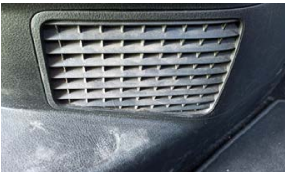
Fot. 3. Wlot powietrza wraz z filtrem do chłodzenia akumulatora trakcyjnego
