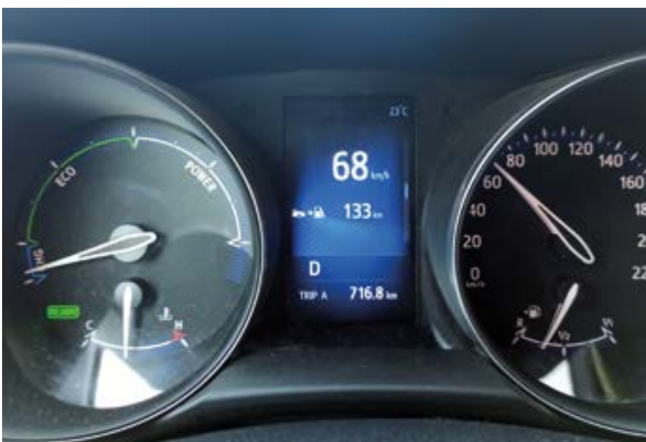
Fot. 9. Delikatne hamowanie podczas zjazdu ze wzniesienia, temperatura akumulatora 49°C. Tryb EV nie jest aktywny
