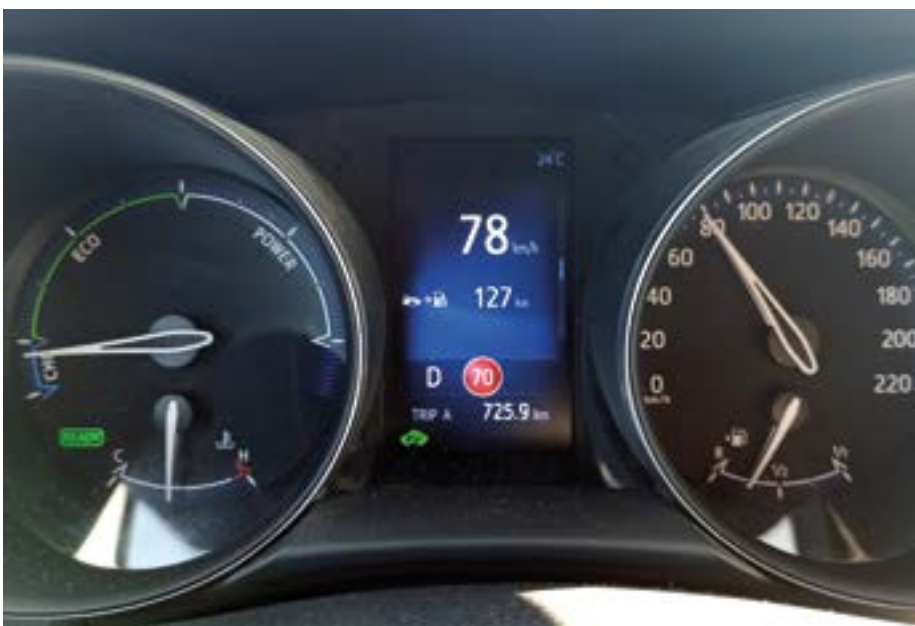
Fot. 8. Delikatne hamowanie i odzysk energii podczas zjazdu ze wzniesienia. Temperatura akumulatora 35°C. Aktywny tryb EV
