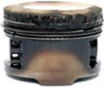
Fot. 1. Zanieczyszczony tłok z zablokowanym pierścieniem spowodowany nadmierną oksydacją oleju silnikowego
