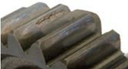
Fot. 2. Uszkodzenie zęba – pitting
