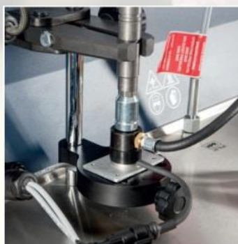
Sensor RSP – czujnik szybkości reakcji wtryskiwacza
