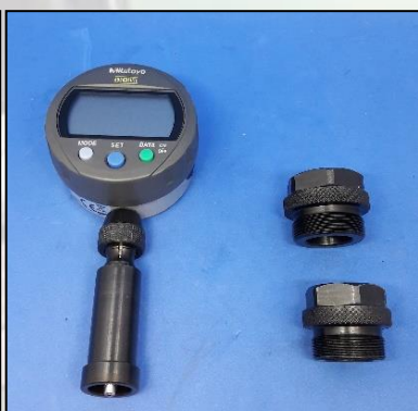
Komparatory, narzędzia pomiarowe, niezbędne tuleje montażowe, adaptory i okablowanie
