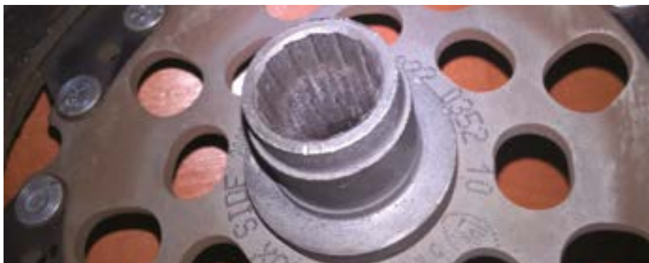
Fot. 1. Uszkodzenie wieloklinu tarczy sprzęgłowej
