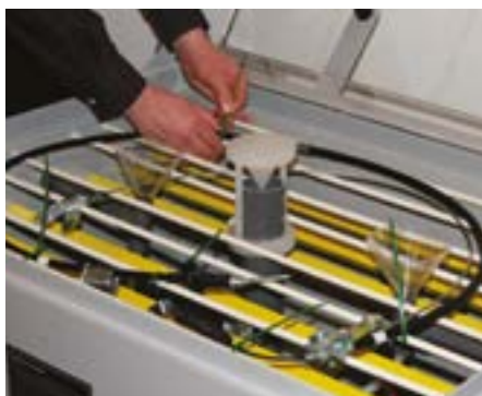
Fot. 2. Odporność linek na korozję jest sprawdzana w komorze solnej
