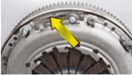
Fot. 4. Otarcia powierzchni wskutek zastosowania zbyt długiej śruby
