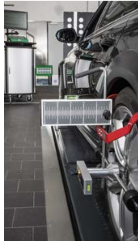
Fot. 2. Wzajemne usytuowanie elementów systemu kalibracyjnego CSC-Tool.
