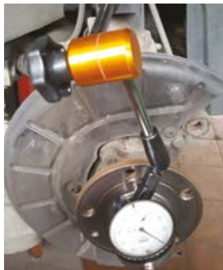
Fot. 2. Pomiar bicia piast wykonuje się czujnikiem zegarowym.
