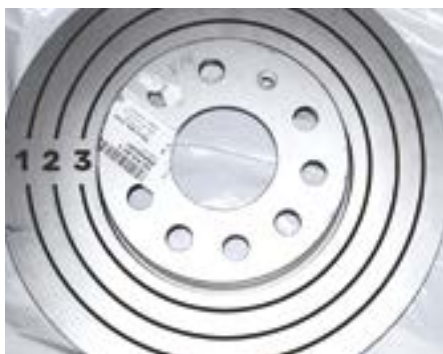
Fot. 1. Osie pomiarowe do pomiaru bicia osiowego tarcz hamulcowych.
