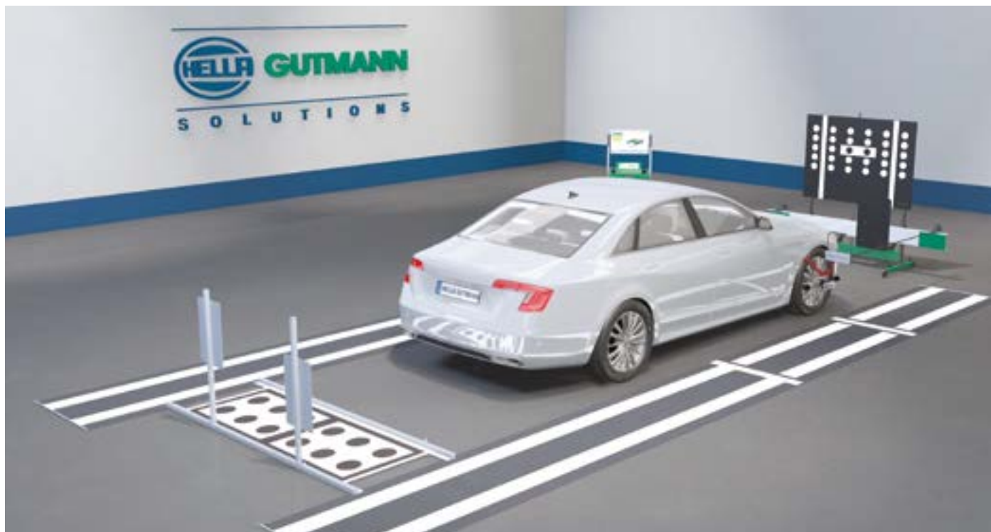
Fot. 1. Pełne stanowisko do kalibracji kamer i radarów systemów wspomaganie kierowcy.
