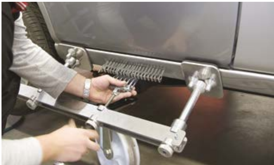
Fot. 5. Belka pozwala na przeniesienie siły na dłuższym odcinku, dlatego wymaga też użycia większej siły. Tutaj jest ona wytwarzana za pomocą śruby, ale są dostępne wersje z dźwignią bądź siłownikiem hydraulicznym lub pneumatycznym. Źródło: Maciej Blum
