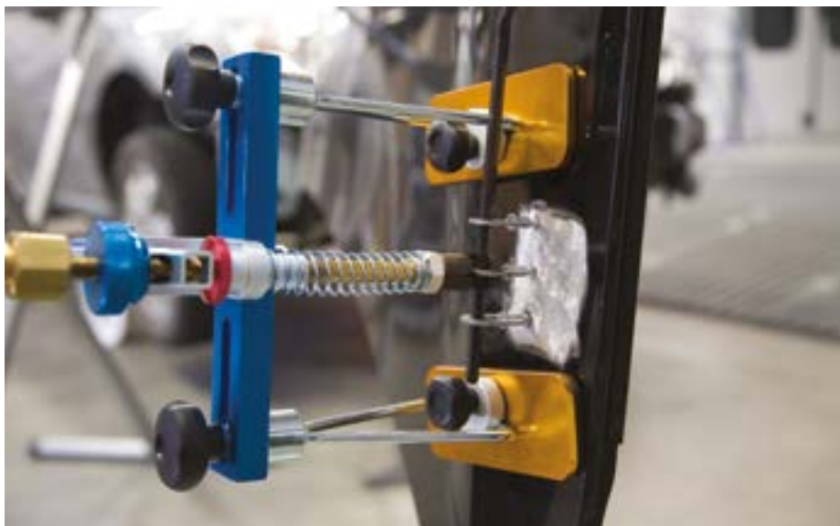
Fot. 6. Naprawa poszycia aluminiowego przebiega w podobny sposób, co stalowego, z tym że detale się różnią. Przykładem jest mocowanie oczek na zgrzane do blachy bolce gwintowane, a nie bezpośrednio, jak ma to miejsce w poszyciu stalowym. Źródło: Maciej Blum
