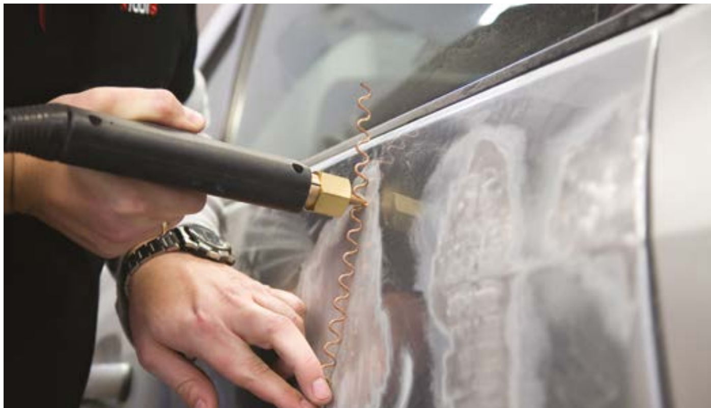
Fot. 1. Zgrzewanie karbowanego drutu do oczyszczonej powierzchni. Źródło: Maciej Blum
