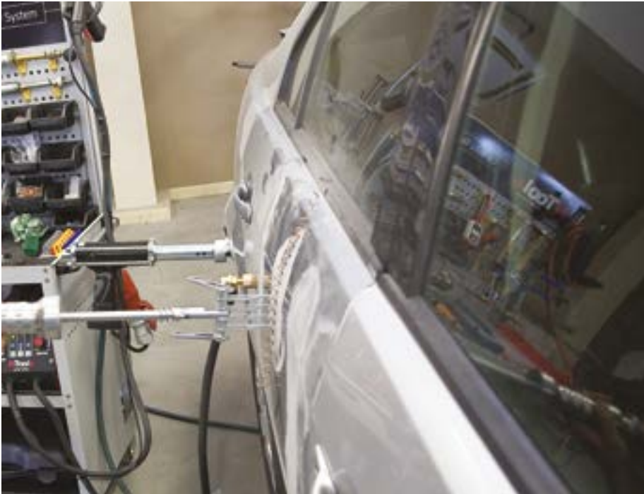
Fot. 2. Wyciąganie wgniecenia młotkiem udarowym wymaga odpowiedniego wyczucia, aby nie oderwać drutu ani nie „przeciagnąć” naprawianego poszycia. Źródło: Maciej Blum
