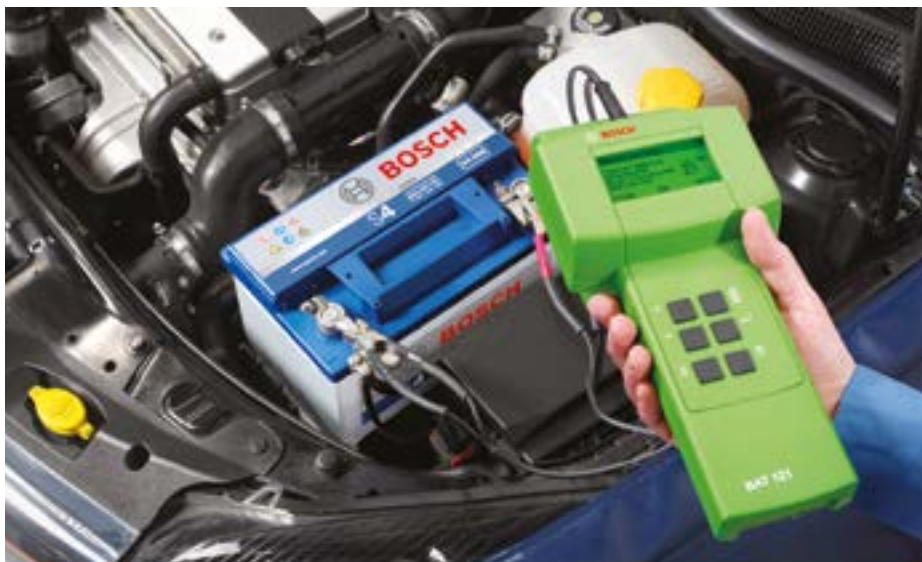
Fot. 5. Bardziej złożona metoda kontroli akumulatora to pomiar napięcia oraz mocy rozruchowej. Źródło: Robert Bosch
