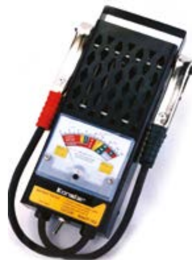
Fot. 6. Najbardziej obciążającym akumulator testem, ale najwięcej mówiącym o jego stanie jest test z pełnym obciążeniem i równoczesny pomiar spadku napięcia. Źródło: Konstar
