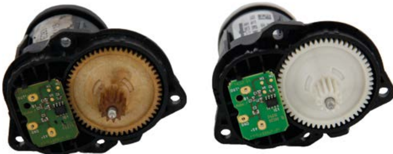
Fot. 5. Zdjęcie wyraźnie pokazuje, w jaki sposób przenika gaz spalinowy, a płytka drukowana i jej elementy są zanieczyszczone od sadzy.
