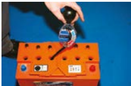
Fot. 4. Najprostszym testem stanu akumulatora jest kontrola gęstości elektrolitu za pomocą aerometru. Źródło: Gunson
