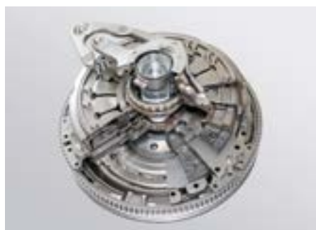
Rys. 2. Sprzęgło wielotarczowe mokre w stanie rozłożonym. Źródło: Archiwum autoEXPERT.
