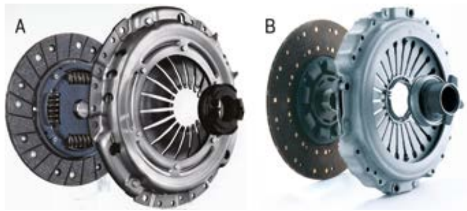
Rys. 6. Oprawa sprzęgła tarczowego z talerzową sprężyną dociskową: A – docisk wciskany, B – docisk wyciągany. Źródło: Archiwum autoEXPERT.
