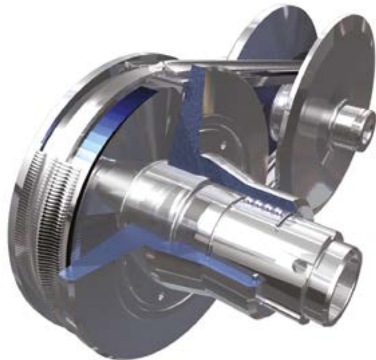
Rys. 13. Schemat wariatora wraz z pasem transmisyjnym wykonanym z taśm stalowych z osadzonymi na nim płytkami. Źródło: Archiwum autoEXPERT.
