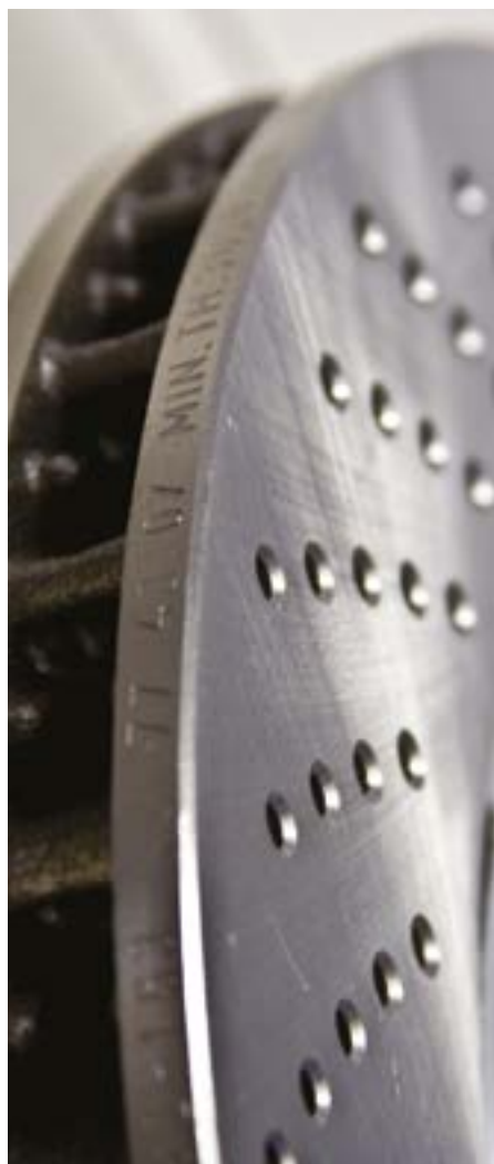
Fot. 1. Kanały wentylujące tarczę hamulcową oraz osiowe wiercone otwory odprowadzające gazy z miejsca styku klocka z tarczą.
