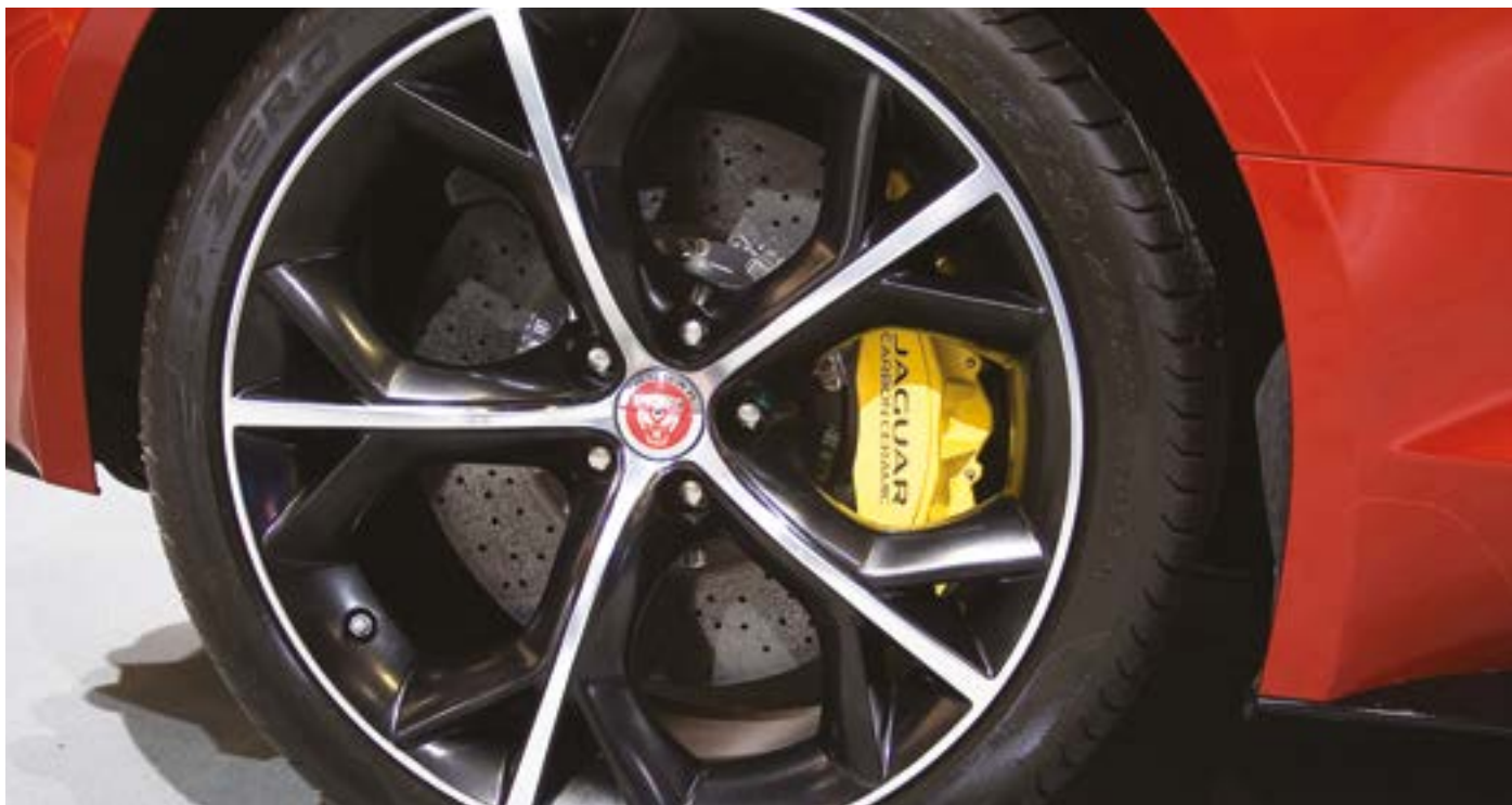
Fot. 2. Hamulec składający się z węglowej tarczy hamulcowej i współpracujących z nią klocków ceramicznych.
