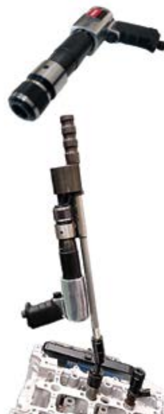
Fot. 1. VIBRO SYSTEM ROOKS w działaniu; młot pneumatyczny OK-04.0100.
