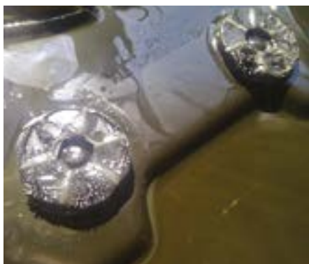
Fot. 1. Miska olejowa Audi A6 o przebiegu 72 000 km [widoczne spore metalowe igły na magnesach].
