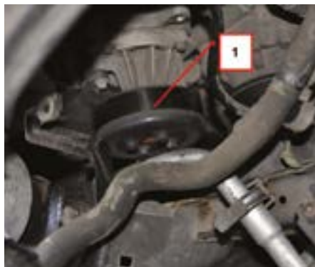
Fot. 2. Koło pasowe pompy wodnej [1] – widok z góry.
