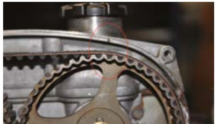
Rys. 6. Znaki odniesienia na kole wałka rozrządu zaworów wydechowych i obudowie głowicy
