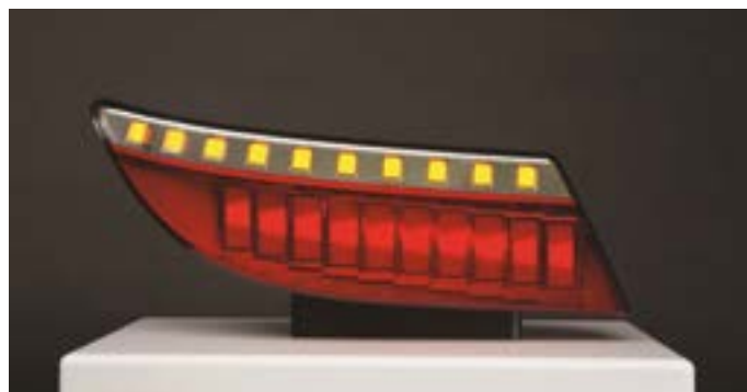
Fot. 5. Samochodowa lampa wykonana w technologii OLED. Światło jest emitowane nie przez punkty, a przez całą powierzchnię.
