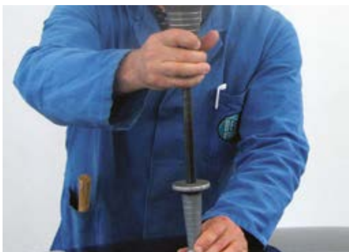
Fot. 2. Do tej samej końcówki można przykręcić cięgło udarowe i w ten sposób naprawić miejsce, w którym niemożliwe jest zastosowanie mostka.
