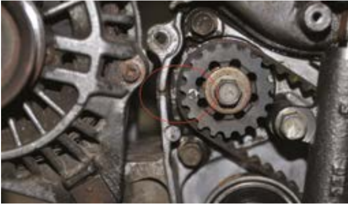
Rys. 3. Znaki odniesienia na kole wałka wyrównowazającego
