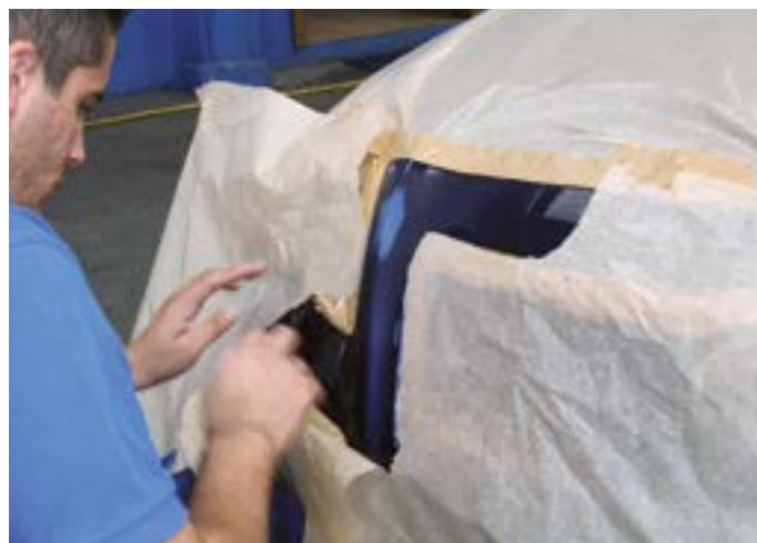
Fot. 6. Oklejenie przylegającej powierzchni zapobiega jej zapyleniu. Osiadający na różnych powierzchniach rozpylony lakier może reagować z oryginalnym lakierem bezbarwnym, tworząc szorstką powierzchnię. Staranne zamaskowanie elementów pozwoli uniknąć dodatkowej pracy po lakierowaniu.
