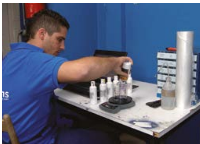
Fot. 5. Lakierowanie punktowe wymaga użycia precyzyjnych wag do odmierzenia bardzo małych ilości potrzebnego lakieru.
