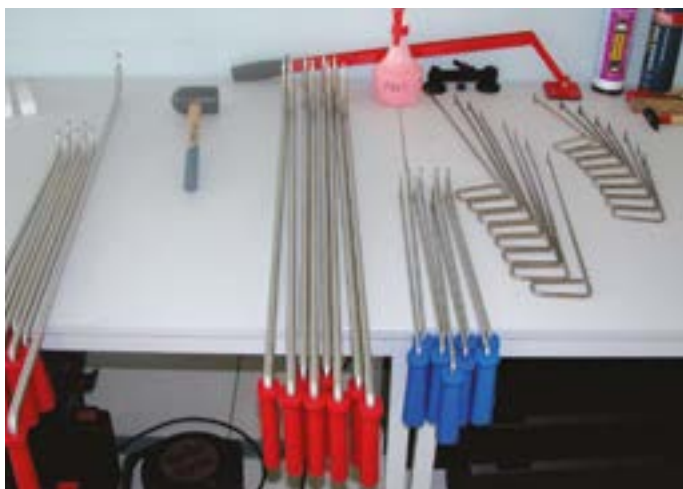
Fot. 3. Usuwanie wgnieceń bez prac lakierniczych jest możliwe dzięki wypychaczom, umożliwiającym dostęp nawet do bardzo trudno dostępnych miejsc.
