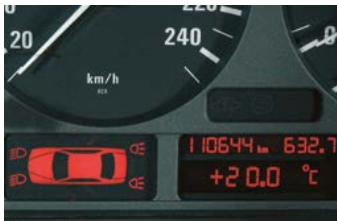
Fot. 9. Po zamianie standardowych żarówek na moduły LED w samochodzie z systemem kontroli żarówek na desce rozdzielczej od razu pojawił się komunikat o uszkodzeniu oświetlenia.
