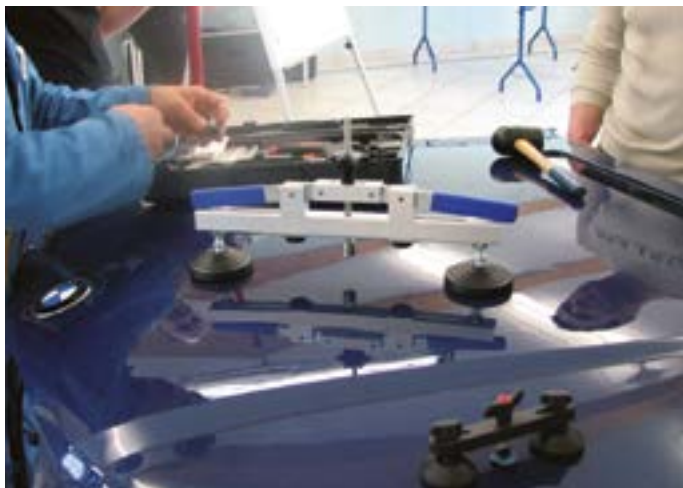
Fot. 1. Dźwignia i mostek pozwalają na „wyciągnięcie” nawet najmniejszych wgnieceń bez konieczności ingerencji w powłokę lakierniczą. Przyklejona do lakieru końcówka pozwala na jej proste usunięcie po naprawie.
