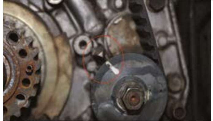
Rys. 4. Znaki odniesienia na kole pompy olejowej
