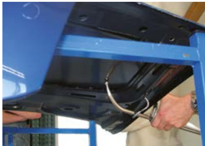
Fot. 4. Niekiedy konieczne jest użycie dodatkowego haka stanowiącego podparcie dla narzędzia.
