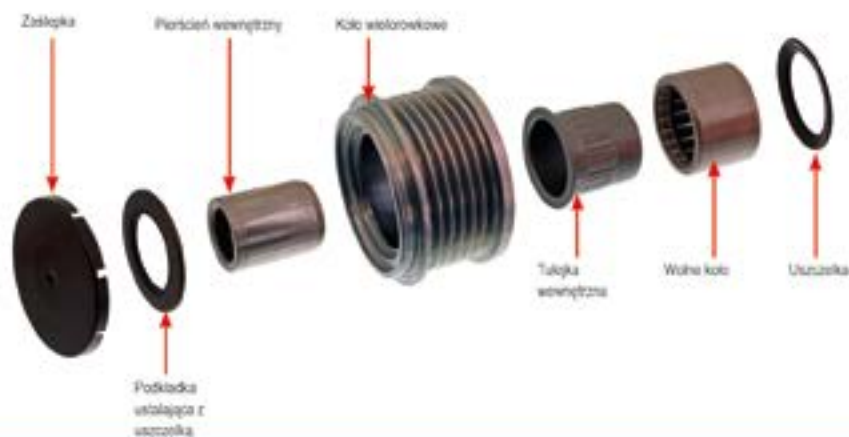
Rysunek 1: Budowa wolnego koła pasowego (OAP)
