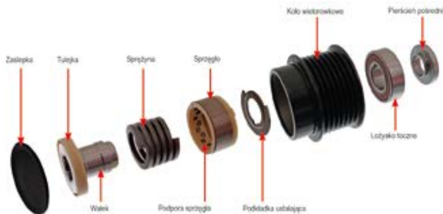
Rysunek 2: Budowa sprzęglika alternatora (OAD)
