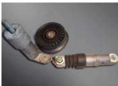
Pęknięty napinacz hydrauliczny
