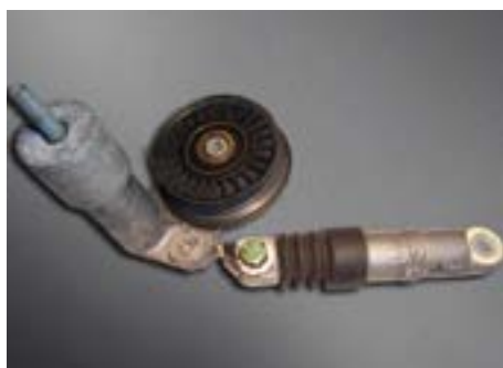
Pęknięty napinacz hydrauliczny
