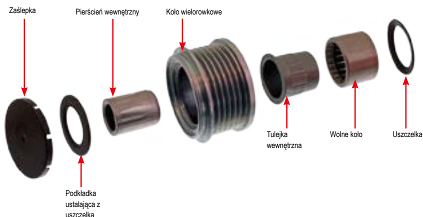
Rysunek 1: Budowa wolnego koła pasowego (OAP)
