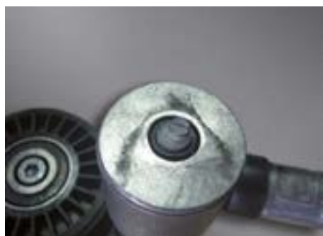
Zerwana śruba mocująca napinacz paska
