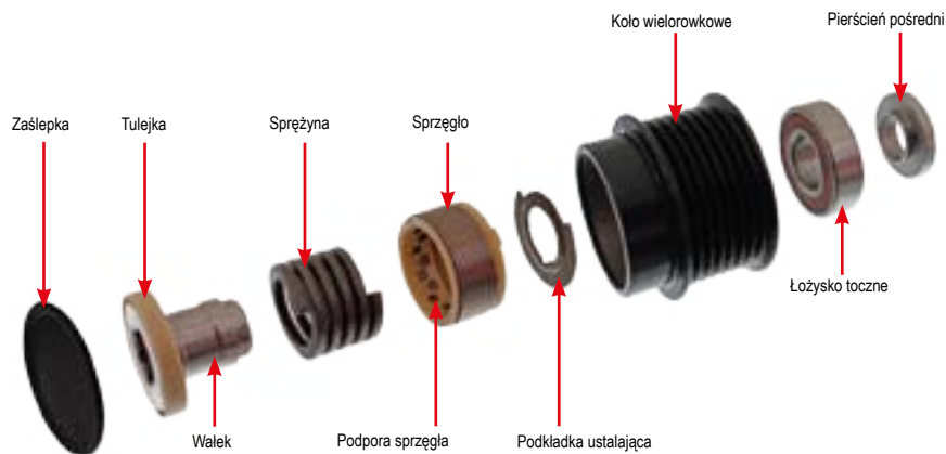
Rysunek 2: Budowa sprzęgielka alternatora (OAD)
