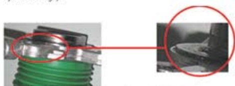
Uszkodzenie CSC w wyniku wywierania ciśnienia zewnętrznego
