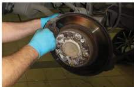
Rys. 1. Kontrola stanu okładzin klocków hamulcowych
