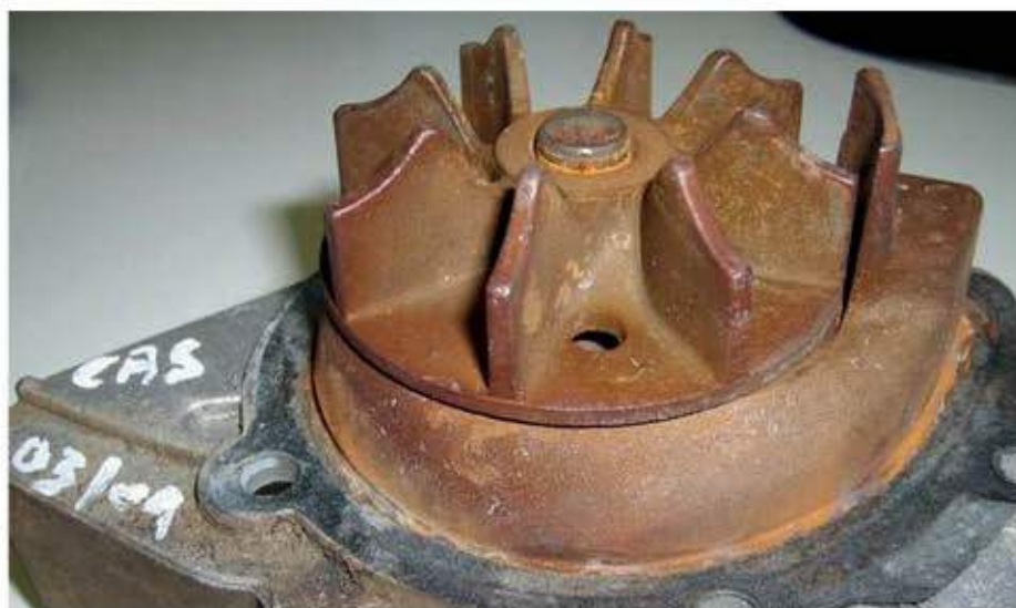
Rys. 3: Korozja w układzie chłodzenia [fot. FEBI BILSTEIN]
