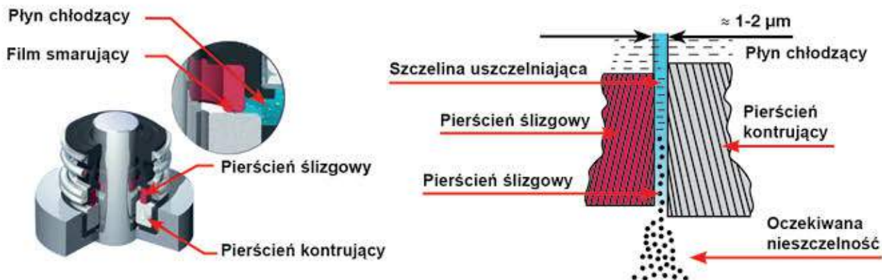
Rys. 2: Oczekiwany poziom nieszczelności pompy wody [1 μm = 0,001 mm] [fot. FEBI BILSTEIN] Strona zewnętrzna
