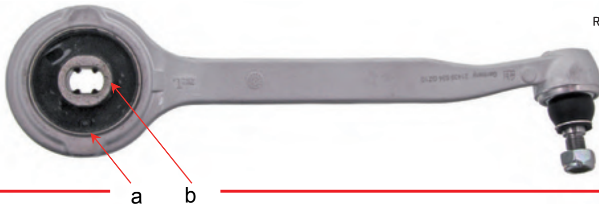
Rysunek 3: Właściwe ustawienie tulejki z tłumieniem hydraulicznym.
