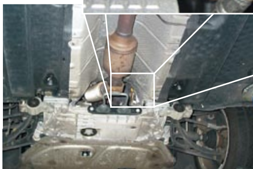
Zawór recyrkulacji powietrza w VW EOS TFSI (zaznaczony na czerwono)
