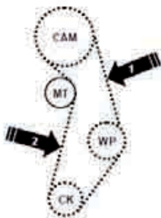
Rys. 3. Schemat sprawdzenia napięcia paska rozrządu w silniku fiat 1.2 benz. typ 188 A4 (WP – pompa wody, MT – napinacz, CAM – wałek rozrządu, CK – wał korbowy)
