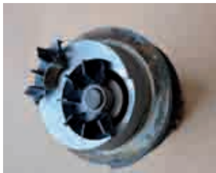
Rys. 7. Uszkodzony (pęknięty) wimnik pompy wody
