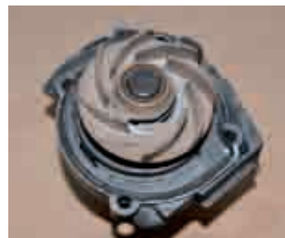
Rys.2. Ostra krawędź wewnętrzna koła pompy
