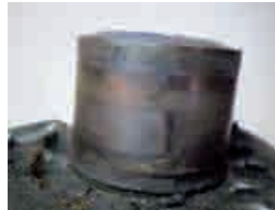
Rys. 4. Zatarta pompa wody krótko po wymianie paska
