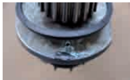
Rys. 8. Zaślepienie otworu odpowietrzającego za pomocą silikonu
