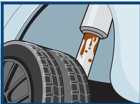
Wyciek oleju na amortyzatorze (Cienka powłoka oleju jest dopuszczalna i służy do smarowania tłoczyska)
