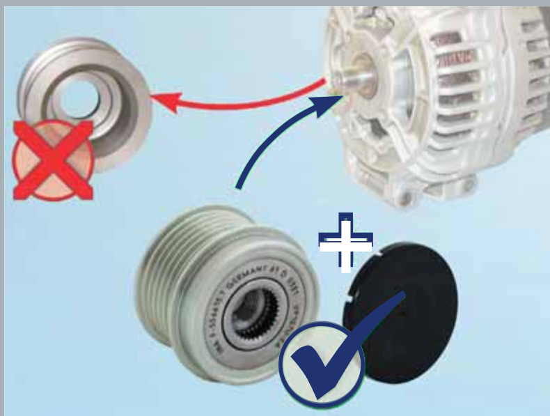
Rysunek 1: Wymiana sztywnego koła pasowego na sprzęgiełko alternatora.
