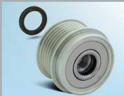
Rysunek 2: Przy zabudowie sprzęgiełka alternatora przy alternatorze Visteon (Ford Mondeo III) należy zastosować dołączoną podkładkę odległościową o grubości 3 mm.
