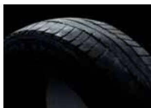
3. Profil opony: nierówności w profilu opony wskazują na uszkodzone amortyzatory
