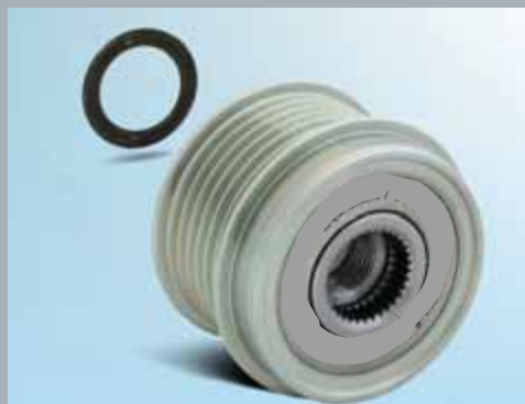
Rysunek 3: Przy zabudowie sprzęgiełka alternatora przy alternatorze Bosch (Ford Transit) należy zastosować dołączoną podkładkę odległościową
