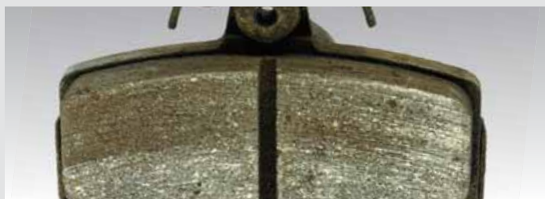
► Zanieczyszczenie powierzchni ciernej
