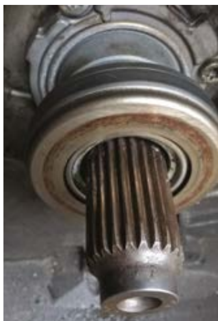
Fot. 1. Zużyty wałek sprzęgłowy
