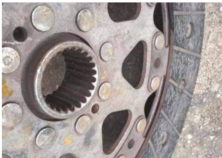
Fot. 2. Zużyty wieloklin przedniej tarczy
