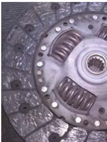
Fot. 1. Przegrzana tarcza sprzęgłowa
