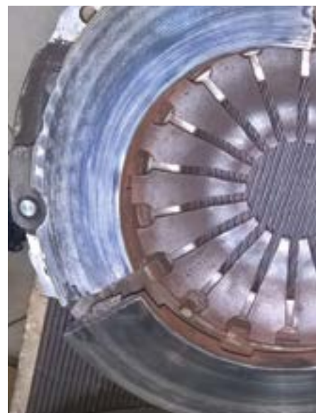
Fot. 2. Pęknięty docisk na skutek przegrzania
