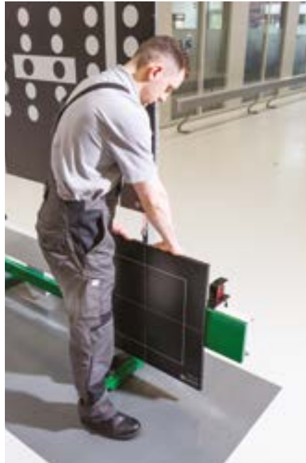
Pracownik montuje na stelażu narzędzia CSC-Tool tablicę odbijającą wiązkę radaru konieczną do kalibracji czujnika radarowego aktywnego tempomatu
