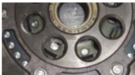
Fot. 2. Uszkodzone koło na skutek zadziałania sprzęgła ITL
