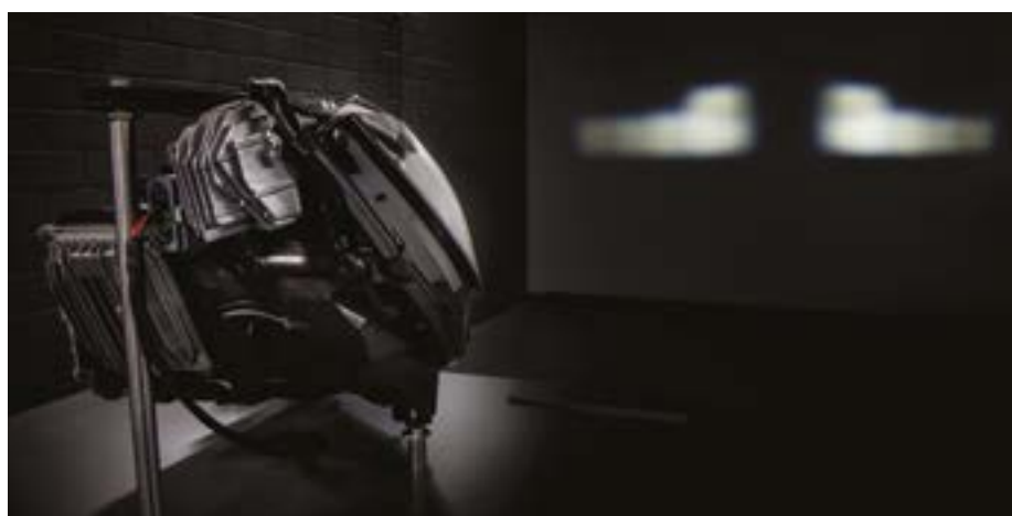
Fot. 6. Zastosowanie odpowiedniego sterowania światłami matrycowymi LED umożliwia zrealizowanie wielostrumieniowego oświetlenia samochodu, dzięki czemu można „omijać” światłem niewralgiczne punkty w jego zasięgu, takie jak piesi czy nadjeżdżające pojazdy, bez utraty widoczności okolicznego terenu. Źródło: Daimler AG
