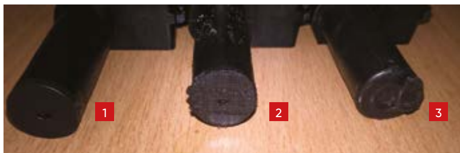
Fot. 4. Różne wersje czujnika prędkości obrotowej wału
