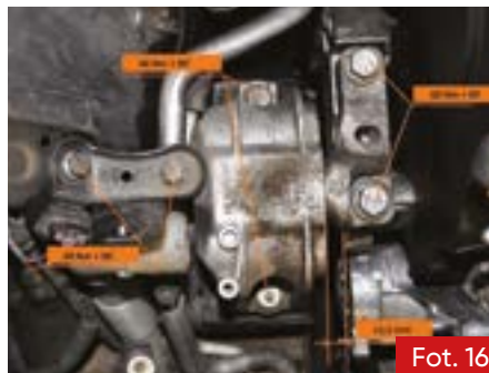
Fot. 16. Momenty dokręcenia śrub prawej poduszki silnika oraz maksymalny odstęp od wspornika prawej poduszki silnika
