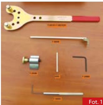
Fot. 1. Narzędzia specjalne niezbędne do wykonania wymiany rozrządu w silniku BXE
