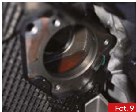
Fot. 9. Miejsce osadzenia pompy wody w bloku
