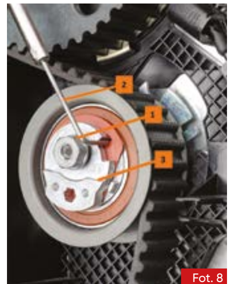
Fot. 8. Układ napinacza paska rozrządu: nakrętka rolki napinającej [1], trzpień blokujący rolkę napinającą T 10265 [2], mimośród rolki napinającej [3]
