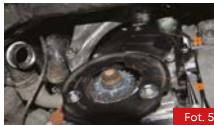
Fot. 5. Osłony paska rozrządu: dolna [1] i środkowa [2]
