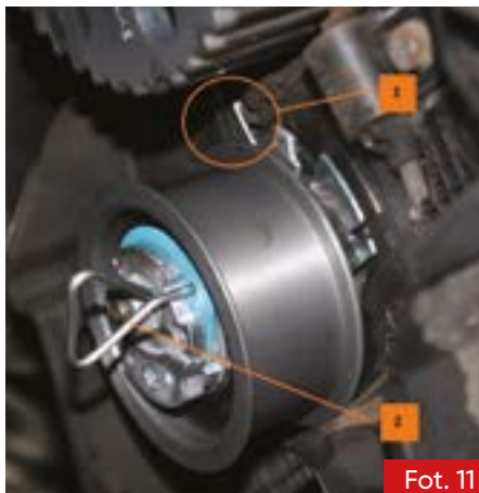
Fot. 11. Położenie rolki napinającej przed montażem paska rozrządu: występ płyty podstawy rolki [1], trzpień blokujący położenie rolki [2]
