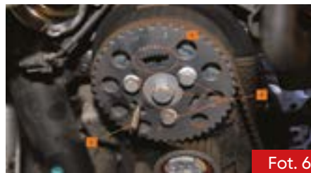
Fot. 6. Położenie znacznika na kole zębatym wałka rozrządu [1] przy GMP wału korbowego oraz sposób zablokowania wałka rozrządu za pomocą narzędzia nr 3359 [2]. Śruby koła zębatego wałka rozrządu [3]
