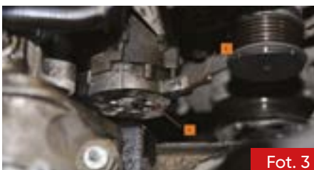
Fot. 3. Zablokowanie napinacza paska wielorowkowego [1] za pomocą narzędzia nr T 10060 [2]
