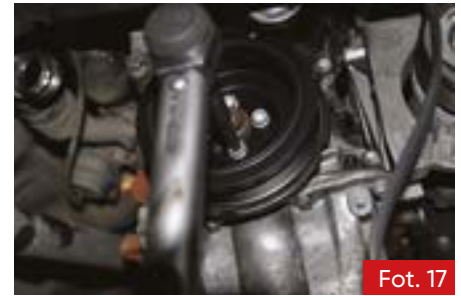
Fot. 17. Prawidłowy montaż koła pasowego paska wielorowkowego. Moment dokręcenia śrub: 10 Nm + 90°
