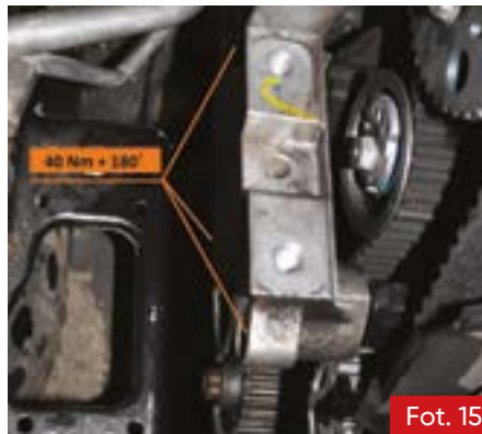
Fot. 15. Moment dokręcenia śrub wspornika prawej poduszki silnika
