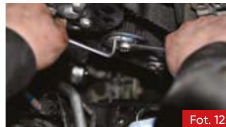
Fot. 12. Sposób regulacji rolki napinającej
