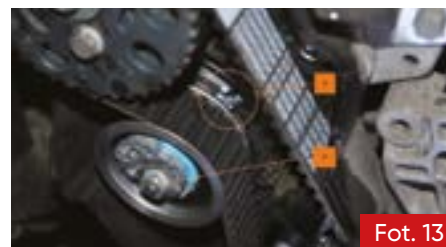
Fot. 13. Prawidłowe ustawienie rolki napinającej [1]. Moment dokręcenia nakrętki: 20 Nm + 45°
