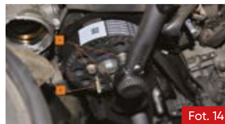
Fot. 14. Prawidłowy sposób dokręcenia śrub koła zębatego wałka rozrządu [1]. Moment dokręcenia: 20 Nm + 45°. Kolek blokujący [2]
