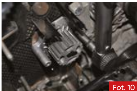
Fot. 10. Prawidłowy sposób dokręcenia śrub mocujących pompę wody. Moment dokręcenia: 13 Nm
