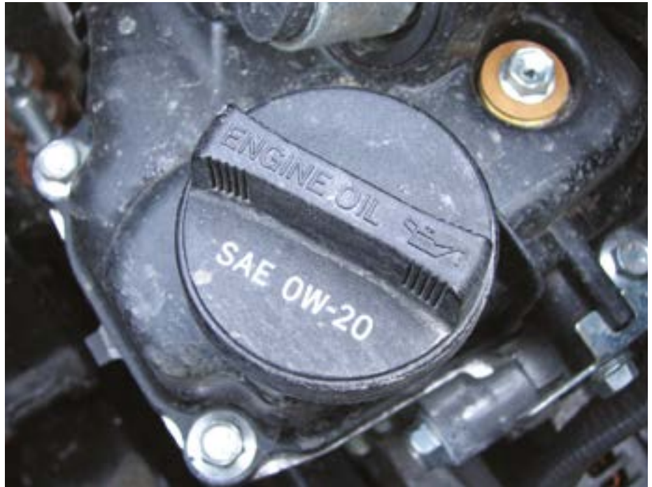
Fot. 3. Olej 0W-20 już nikogo nie dziwi. Można już kupić oleje 0W-16, a lada chwila pojawi się 0W-12. Aktualnie trwają prace nad dostosowaniem norm do olejów o niższych lepkościach. Źródło: guideautoweb
