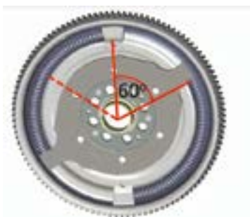
Rys. 1. Pełne ugięcie sprężyn łukowych wewnątrz DKZ wynosi 60°
