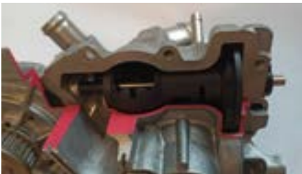
Fot. 4. Widok przesłony regulującej przepływ cieczy. Przekrój nastawnika. Akademia Szkoleń Auto Partner SA
