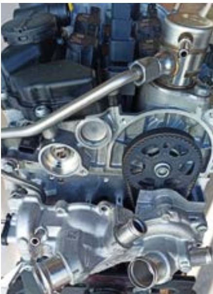
Fot. 5. Nastawnik przepływu cieczy zabudowany na silniku 1.5TSI DACA. Akademia Szkoleń Auto Partner SA
