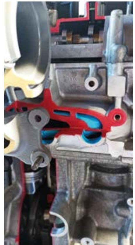
Fot. 6. Przekrój głowicy, widoczny kanał przepływu spalin oraz kanały przepływu cieczy (kolor niebieski)
