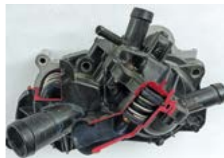
Fot. 2. Przekrój korpusu pompy wody z widocznymi dwoma termostatami 1.4TSI CMBA. Akademia Szkoleń Auto Partner SA
