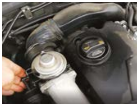
Fot. 4. Ręcznie wystosowując przepustnicę weryfikujemy stuki podczas gaszenia silnika
