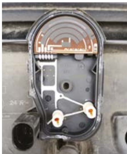
Fot. 3. Wytarte ścieżki potencjometru
