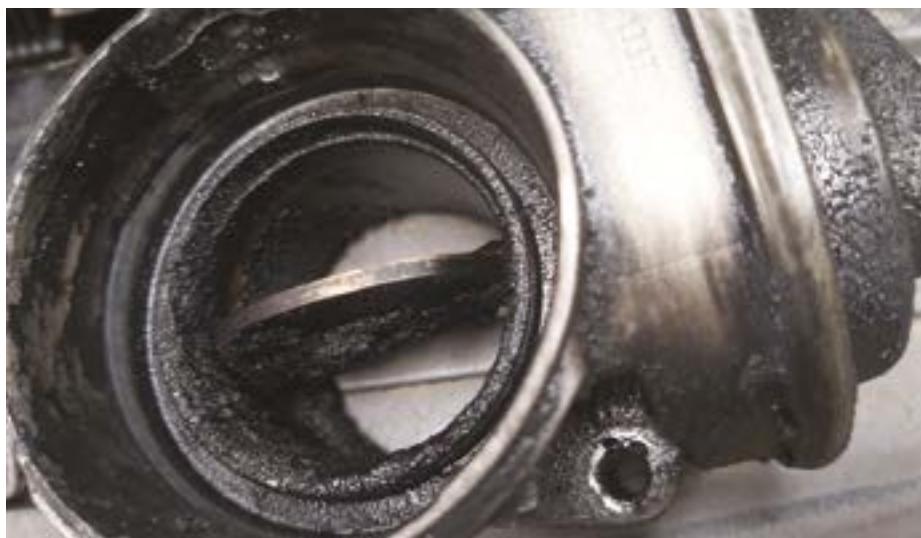
Fot. 1. Uszkodzona przepustnica w Outlanderze
