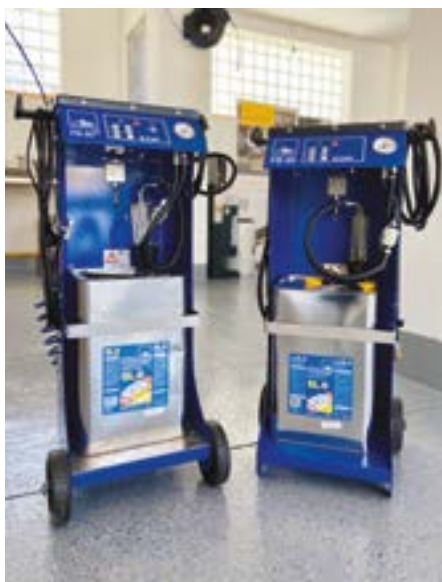
Fot. 4. Zalecane przez producenta systemów hamulcowych, firmę ATE, urządzenia do wymiany płynu hamulcowego: ATE FB30, FB30SR
