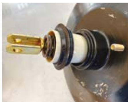
Fot. 2 i 3. Tuleja prowadząca i uszczelniacz „serwa”
