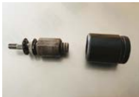
Fot. 3 i 4. Mechanizm wewn. zacisku z widocznymi kulkami
