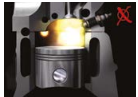
Fot. 5. Widoczne po lewej stronie drugie miejsce spalania mieszaniny paliwa z powietrzem – stan niepożądany
