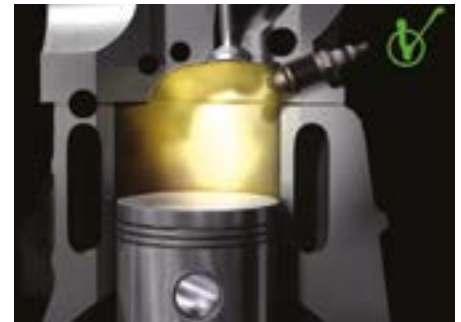
Fot. 4. Prawidłowe spalanie się całej dawki paliwo-powietrznej
