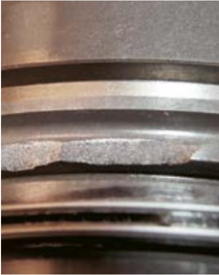
Fot. 2. Złamane progi pierścieni tłokowych przez wadliwy montaż
