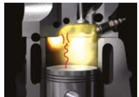
Fot. 6. Dwie fale uderzeniowe (większa i mniejsza) w miejscu zderzenia uderzają wspólnie w denko tłoka np. podczas jego posuwu w dół
