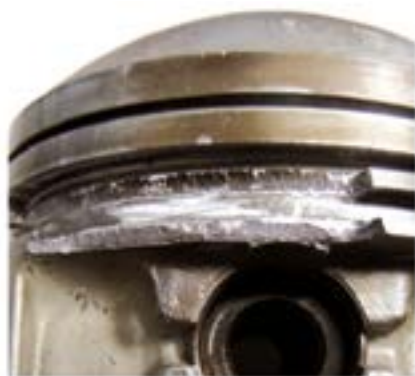
Fot. 1b. Powtórne zdjęcie przebiegu pęknięcia od góry w dół
