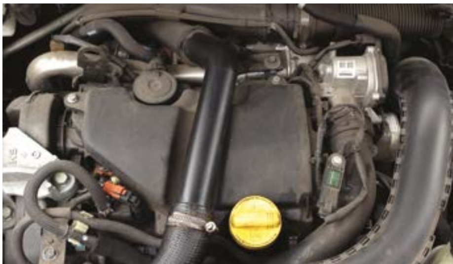
Fot. 2. Przykład: pokrywa głowicy silnika z zaworem wentylacyjnym
