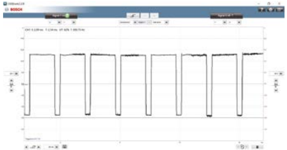
Fot. 5. Sygnał sterujący wentylatorem, maksymalna prędkość obrotowa. PWM = 82%, f = 393 Hz
