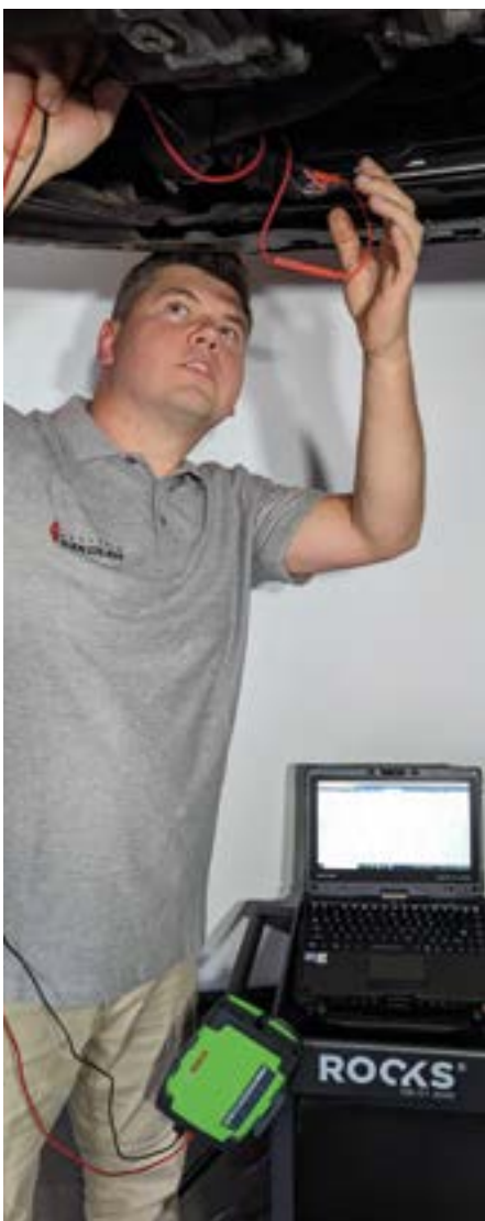
Fot. 3. Wpięcie oscyloskopu w module KTS do instalacji elektrycznej pojazdu, Pin3 złącze C05
