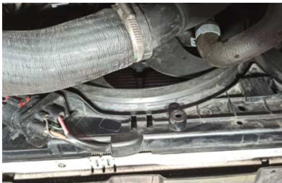
Fot. 2. Złącze elektryczne C05 widoczne w dolnej części zespołu wentylatora
