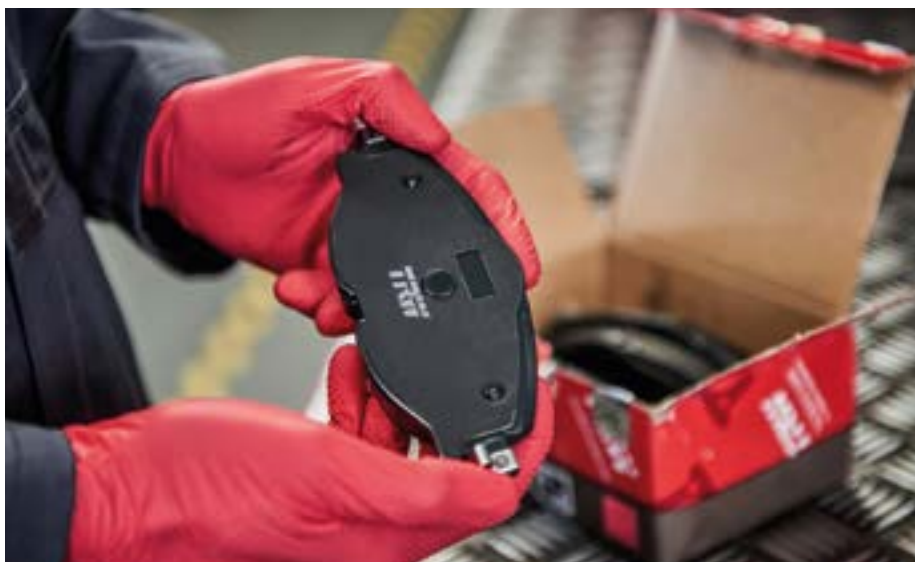
Fot. 3. Przy sprawdzaniu stanu klocków hamulcowych należy zwrócić uwagę na ewentualne uszkodzenia lub spękania materiału ciernego oraz korozję płytki tylnej
