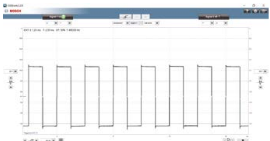
Fot. 7. Niepoprawny przebieg oscyloskopowy sygnału sterującego zaworem elektromagnetycznym. Zbyt niska amplituda sygnału osiągająca wartość 10,8 V. Oznacza to ponadnormatywną rezystancję w obwodzie elektrycznym sterownik-zawór lub nieprawidłowe zasilanie sterownika, lub błędnie działający system ładowania w pojeździe. Oscyloskop Bosch KTS 590
