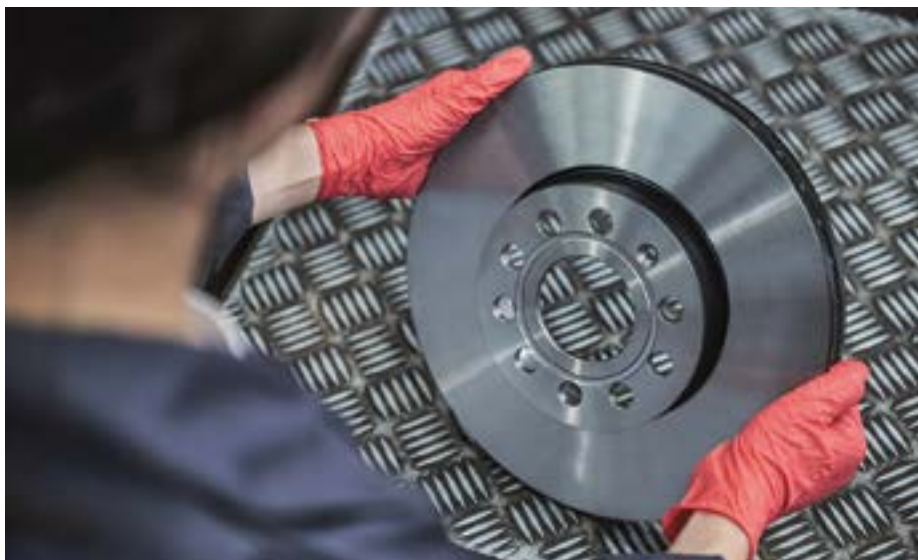
Fot. 1. By ocenić zużycie tarcz hamulcowych, przede wszystkim należy zmierzyć ich grubość. Minimalna, bezpieczna wartość określana jest przez producenta i zazwyczaj znajduje się na bocznej krawędzi elementu
