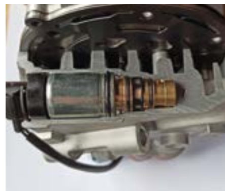
Fot. 1. Zawór elektromagnetyczny osadzony w sprężarce. Przekrój kompresora
