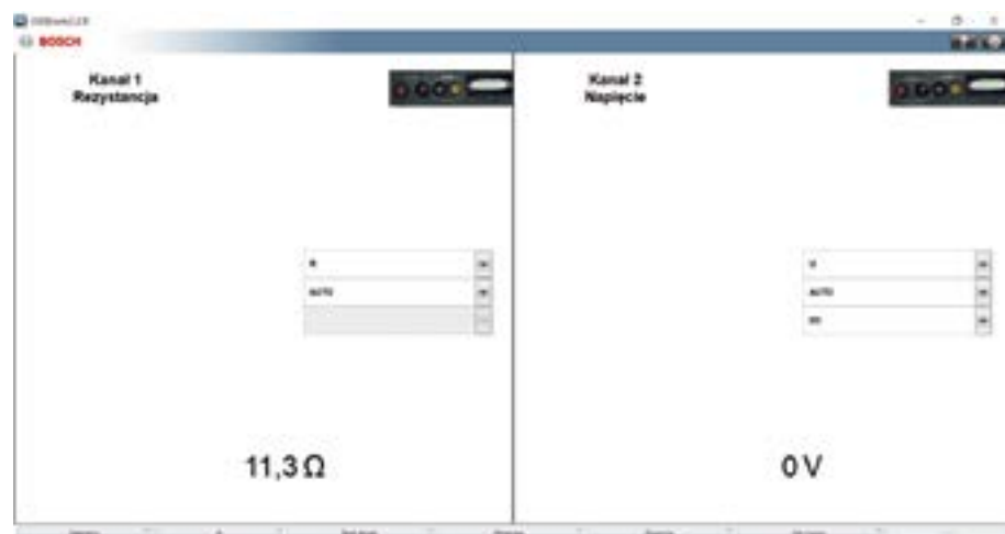
Fot. 3. Pomiar rezystancji zaworu elektromagnetycznego
