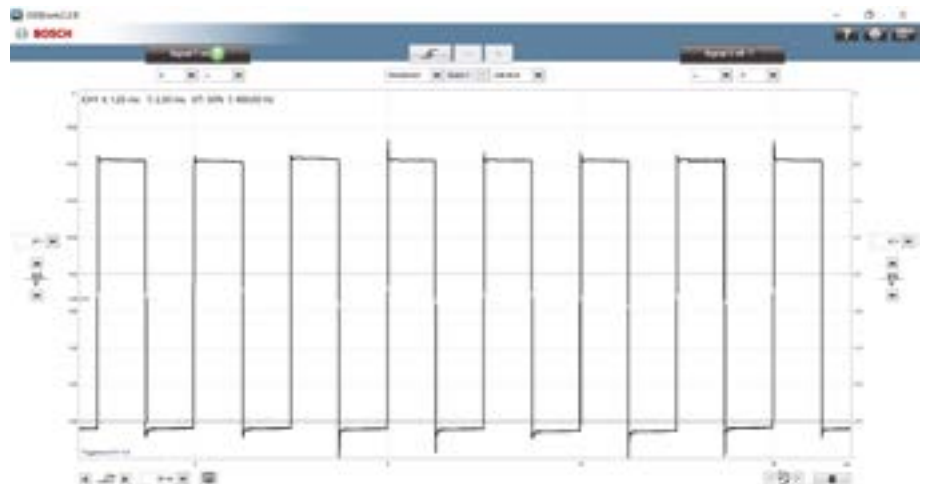
Fot. 6. Poprawny przebieg oscyloskopowy sygnału sterującego zaworem elektromagnetycznym. Oscyloskop Bosch KTS 590, automatyczny pomiar PWM oraz częstotliwości widoczne w lewym górnym rogu oscylogramu. Amplituda sygnału 14,2 V
