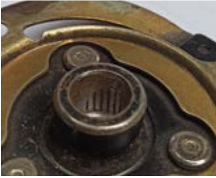
Fot. 4. Uszkodzony wewnętrzny wielofrez tarczy sprzęgła
