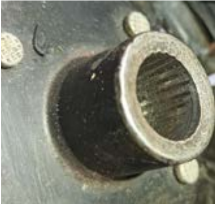
Fot. 5. Uszkodzony wewnętrzny wielofrez tarczy sprzęgła
