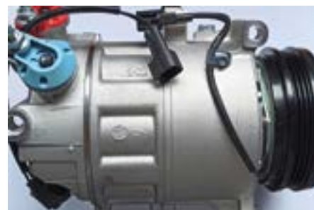
Fot. 2. Sprężarka z widocznym zaworem i sprzęgłem elektromagnetycznym. Widoczne dwa złącza elektryczne
