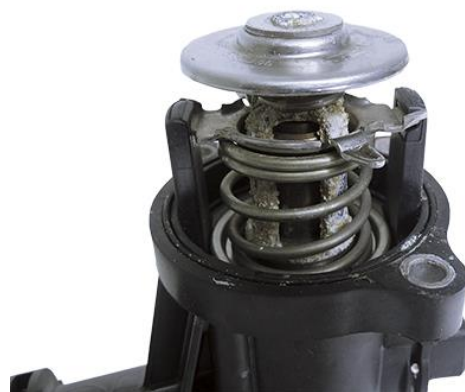
Fot. 2. Termostat po użyciu nieodpowiedniego chłodziwa. Doprowadziło to do korozji aluminium, "rozpuszczenia" aluminiowej części (Photo credit: Mahle)
