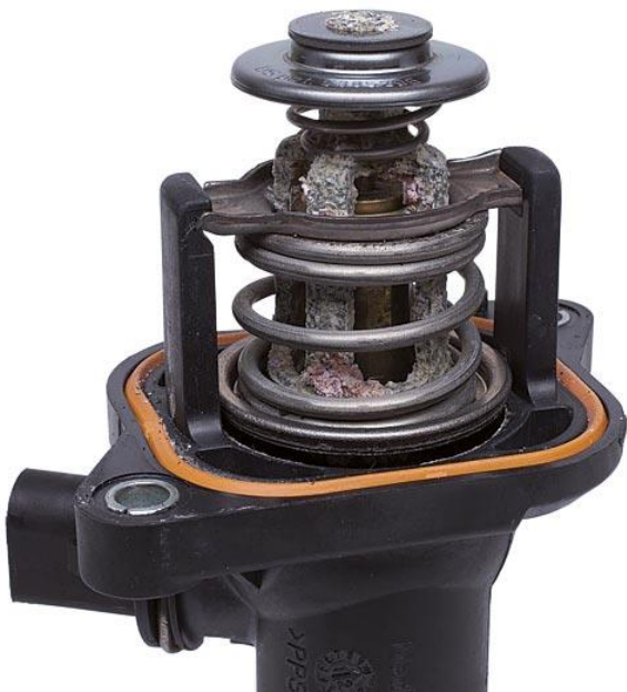
Fot. 1. Termostat MAP z widocznymi oznakami korozji (Photo credit: Mahle)
